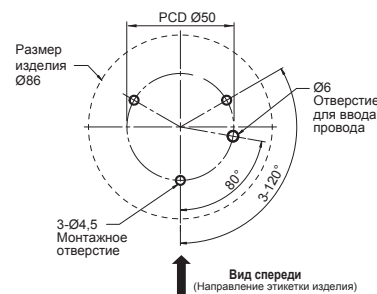
▲ Схема расположения отверстий для шпилек
