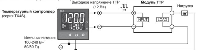
Ж Независимо от выбора функции управления (фазовое или циклическое управление), для питания нагрузки и температурного контроллера следует использовать один источник питания.
