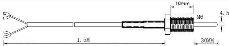
TS1-K-4.5-50-M8-S2-1.5-U Термопара типа К, защитная трубка диаметром 4,5 мм и длиной 50 мм, с вращающейся гайкой M8x10, кабель 1,5 м
