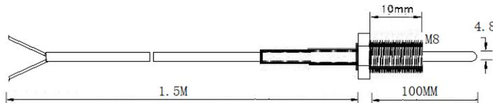
TS2-K-4.8-30-M8-S2-1.6M-U Термопара типа К, защитная трубка диаметром 4,8 мм и длиной 30 мм, с неподвижной гайкой M8x10, кабель 1,6 м
