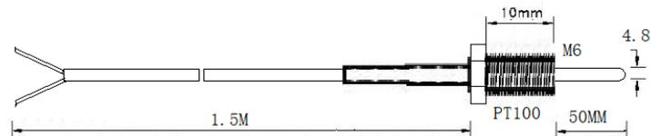
TS2-K-4.8-250-M6-S1-1.5-M-U Термопара типа К, защитная трубка диаметром 4,8 мм и длиной 250 мм, с неподвижной гайкой M6x10, кабель 1,5 м
