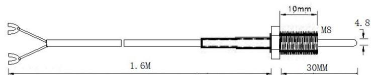
TS2-K-4.8-50-M8-S2-1.7M-U Термопара типа К, защитная трубка диаметром 4,8 мм и длиной 50 мм, с неподвижной гайкой M8x10, кабель 1,7 м
