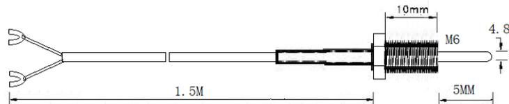
TS1-PT-4.8-50-M6-T1-1.5M-U Термосопротивление Pt100, защитная трубка диаметром 4,8 мм и длиной 50 мм, с вращающейся гайкой M8x10, кабель 1,5 м
