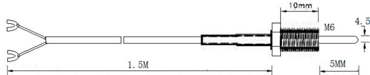
TS1-K-4.5-30-M6-S2-1.5-U Термопара типа К, защитная трубка диаметром 4,5 мм и длиной 30 мм, с вращающейся гайкой M6x10, кабель 1,5 м
