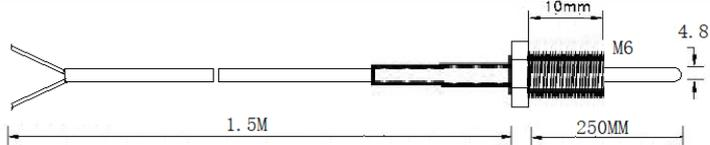
TS2-K-4.8-100-M8-S2-1.5M-U Термопара типа К, защитная трубка диаметром 4,8 мм и длиной 100 мм, с неподвижной гайкой M8x10, кабель 1,5 м
