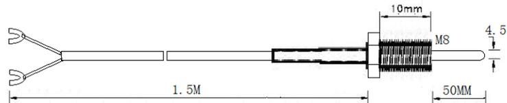
TS1-K-4.8-100-M8-S2-1.5M-U Термопара типа К, защитная трубка диаметром 4,8 мм и длиной 100 мм, с вращающейся гайкой M8x10, кабель 1,5 м
