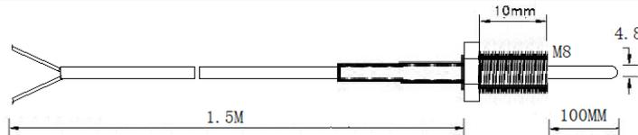
TS1-K-4.8-5-M6-S1-1.5M-U Термопара типа К, защитная трубка диаметром 4,8 мм и длиной 5 мм, с вращающейся гайкой M6x10, кабель 1,5 м
