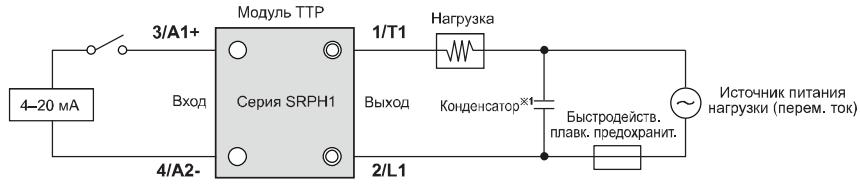
※ 1: Для обеспечения электромагнитной совместимости необходимо подключить конденсатор в соответствии с приведенной выше схемой.
