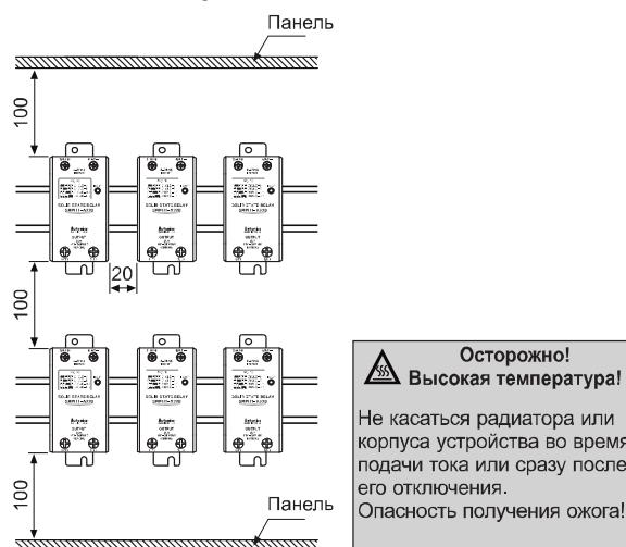
※ Для предотвращения перегрева в случае монтажа нескольких твердотельных реле необходимо соблюдать указанные на схеме монтажные расстояния.
