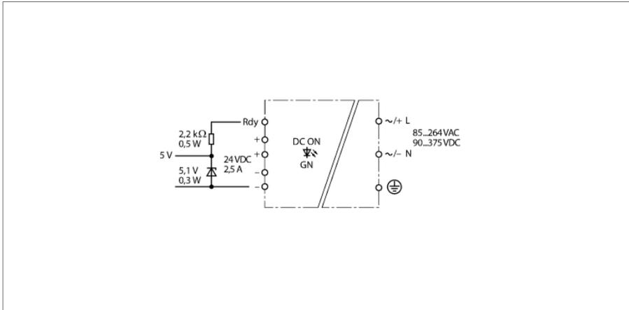
Блоки питания IM82-24-2,5 предназначены для нагрузок постоянного тока, например для переключающих устройств и устройств контроля TURCK серий IM, IME, IMS и IMC.
