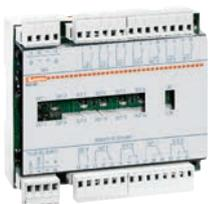
Блоки позволяют передавать на неполярные контакты состояния и сообщ. тревоги блоков управления RGK 800 и 900.
