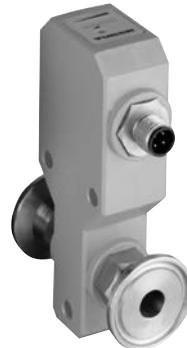
Inline-Strömungssensoren von Turck erfassen kleinere bis mittlere Durchflussmengen. Es können Wasser, Öle, Alkohole, Lacke sowie nicht explosive Flüssigkeiten und Gase überwacht werden. Die Sensoren arbeiten nach dem kalorimetrischen Prinzip und sind somit verschleißfrei.
