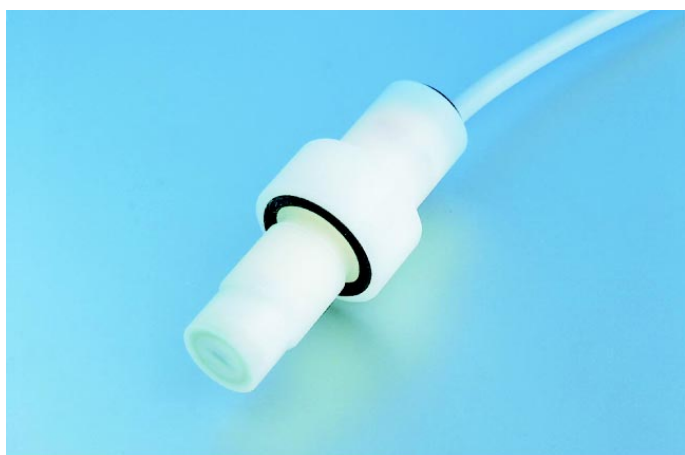
датчики для агрессивных сред в цилиндрических пластмассовых корпусах из дифлора (устойчивы к большинству химикатов) с резьбой M18x1, M30x1,5 и без резьбы Ø 34 мм подключение через кабель
