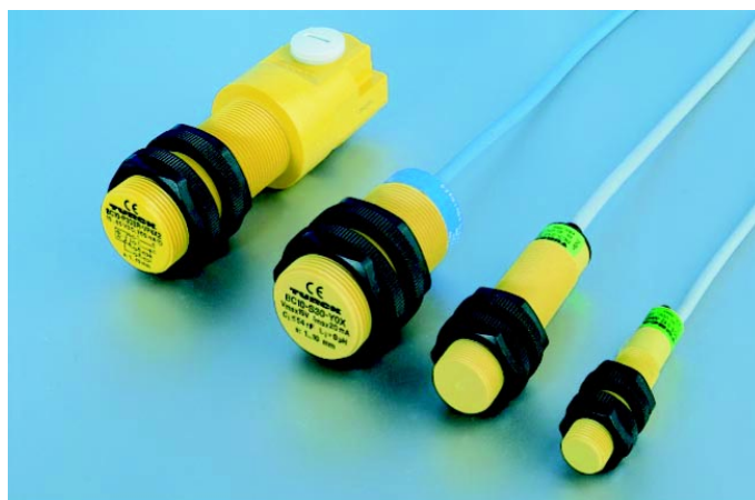
датчики в цилиндрических пластмассовых корпусах с резьбой M12x1, M18x1, M30x1,5 и без резьбы Ø 40 мм подключение через кабель, разъем или клеммы
