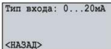
Рисунок 7.2.6 – Экран настройки датчика аналогового тока
