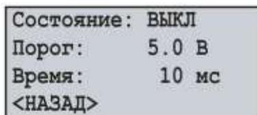
Рисунок 7.5.5 – Экран настройки верхнего или нижнего порогов события
