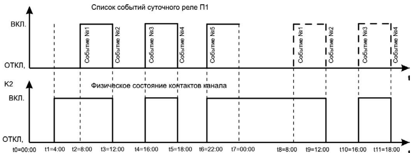
Рисунок 2.8 - Режим циклического выполнения списка таймеров на примере суточного реле времени
