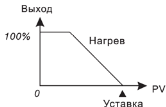
Рис 3: ПИД-регулирование, управление нагревом
