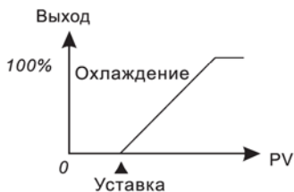
Рис 2: ПИД-регулирование, управление охлаждением
