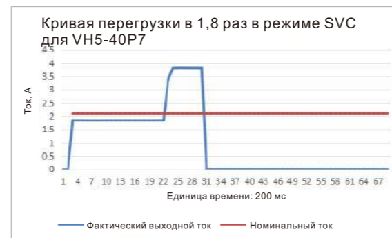
Время перегрузки преобразователя частоты VH5 в 1,8 раза: 1 секунда
