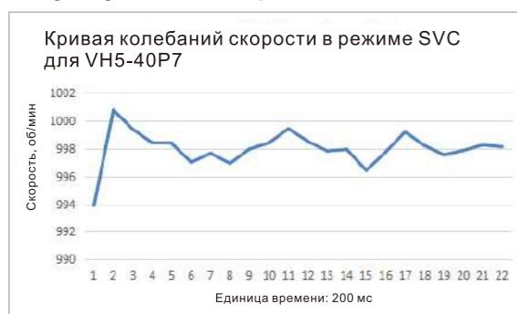
Флуктуация скорости преобразователя частоты VH5: ±0.3%
