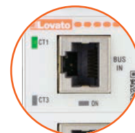
Светодиодные индикаторы правильности автоконфигурации и сопряжения
