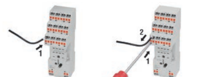
Втычное подсоединение push-in без использования отвертки Отсоединение кабелей с помощью отвертки
