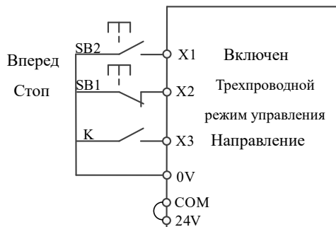
NPN-подключение с открытым стоком
