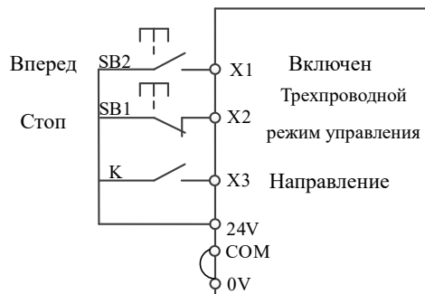
PNP-подключение с открытым коллектором
