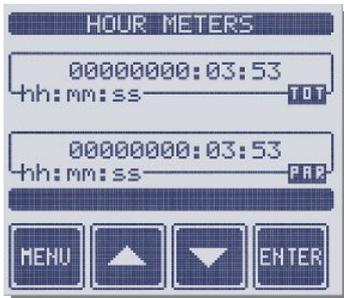
Прибор так же имеет общие и частичные счетчики, которые позволяют определить время с начала включения прибора и время с момента наступления события, заданного пользователем, например, превышение коэффициента мощности.
