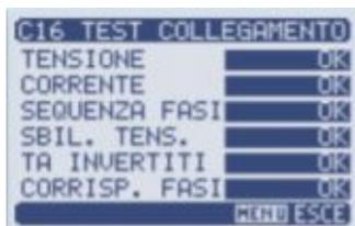
Когда присоединение завершено, пользователь может немедленно проверить правильность соединения, используя встроенную программу проверки. Это позволяет определить наличие напряжения, тока, правильность чередования фаз и дисбаланс фаз, а также обратное подключение трансформаторов тока или соответствие между напряжением и током.
