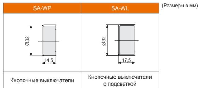
※ Эти водонепроницаемые колпачки применяются только для серии S2R (круглые выключатели выступающего типа). При их использовании степень защиты - IP65
