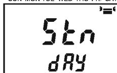
Нажмите сначала клавишу **[>]** для перехода к значку субботы, потом клавишу **[SET]**, чтобы выбрать субботу в качестве стандартного дня (значок Sat загорается) с помощью клавиш **[▲]** или **[▼]**.
